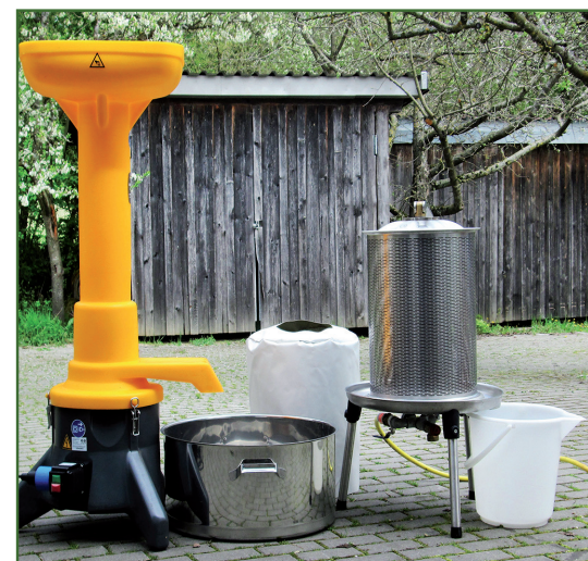
Eine 40-Liter-Hydropresse in Edelstahlausführung mit Häcksler, Maischewanne und Saftimer wartet auf ihren Einsatz.
