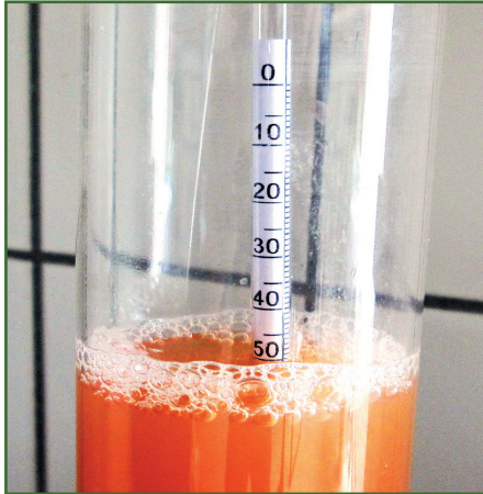
Bei der Oechsle-Waage wird der Zuckergehalt an der Skala abgelesen. Bei Waagen ohne Temperaturkompensation ist auf die korrekte Safttemperatur zu achten!
