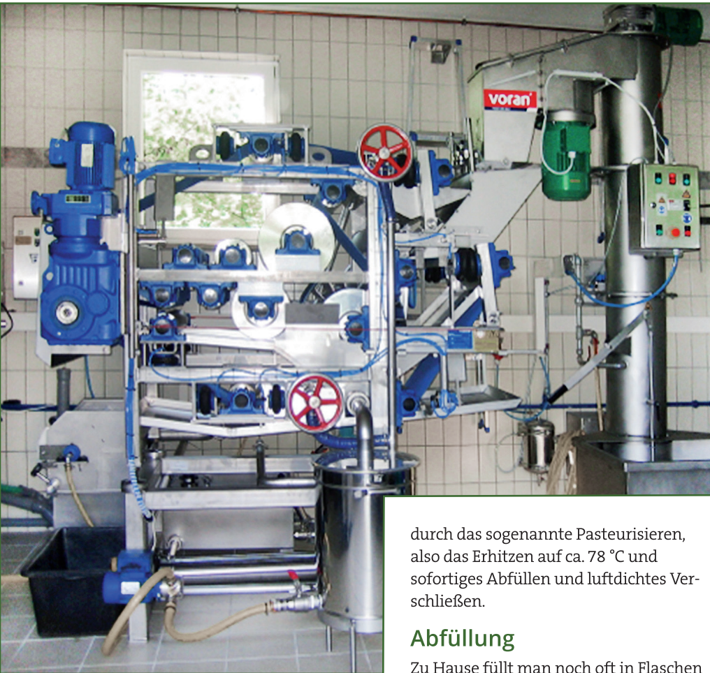
Eine Zweibandpresse mit Wasch- und Mahlanlage in einer kleinen gewerblichen Mosterei
