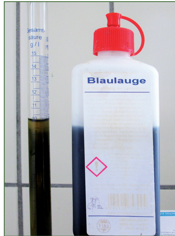
Bestimmung des Gesamtsäuregehaltes mit Hilfe eines Acidometer-Sets
