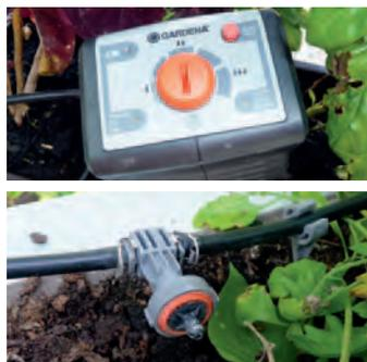
*Einige vollautomatische Bewässerungsverfahren benötigen u. a. Bewässerungscomputer, Feuchtesensor, Verteilerleitung, entsprechende Tropfer, Druckminderer und mehr. Das alles ist nicht ganz billig, erleichtert aber die Arbeit ungemein.*
