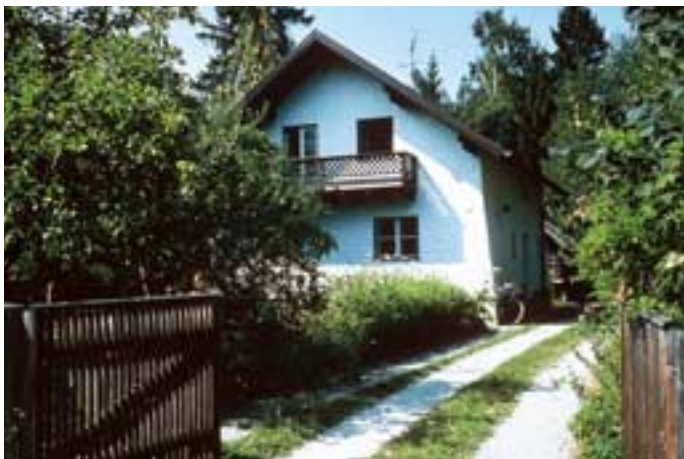
Bei langen Zufahrten bietet es sich an, nur die Fahrspuren zu befestigen und den Mittelstreifen offen zu lassen. Ein paralleler Gehweg aus Platten oder Pflaster sorgt für „saubere Füße“.
