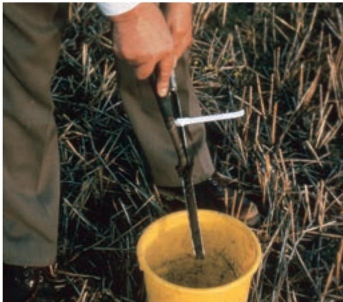
Mit dem Bohrstock werden Einzelproben genommen, in einem Eimer gesammelt und zu einer Mischprobe vereinigt.
