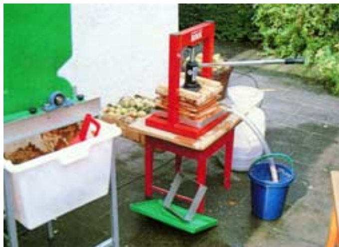
Mit einfacher Hydraulik betriebene Packpressen bringen hohen Druck und liefern sehr gute Ergebnisse.
