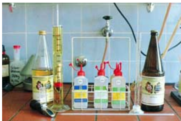
Einfache Geräte und Hilfsmittel ermöglichen ohne viel Aufwand die Bestimmung von Oechslegraden, Gesamtsäure, freier und gesamter schwefliger Säure.
