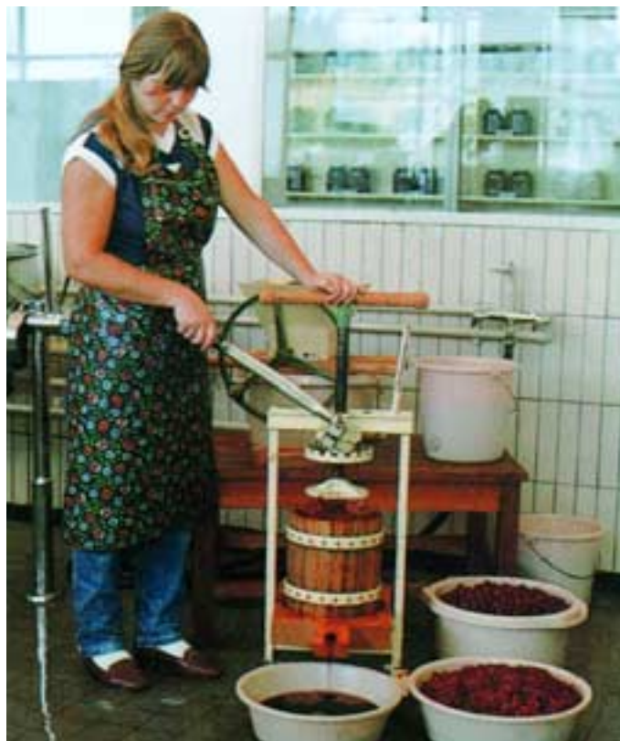
Kleinkorbpressen, hier beim Pressen von Sauerkirschen, sind für alle Obstarten gleich gut geeignet.
